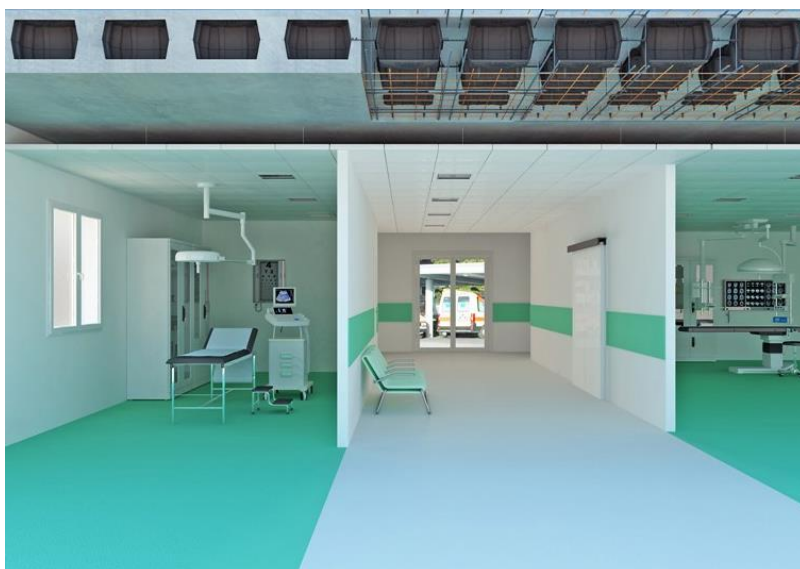
Рис.2.5 Кесонне перекриття – а; процес монолічення кесонного перекриття –б; кесонна конструкція обумовлює гладку стелю, придатну до опорядження – в
