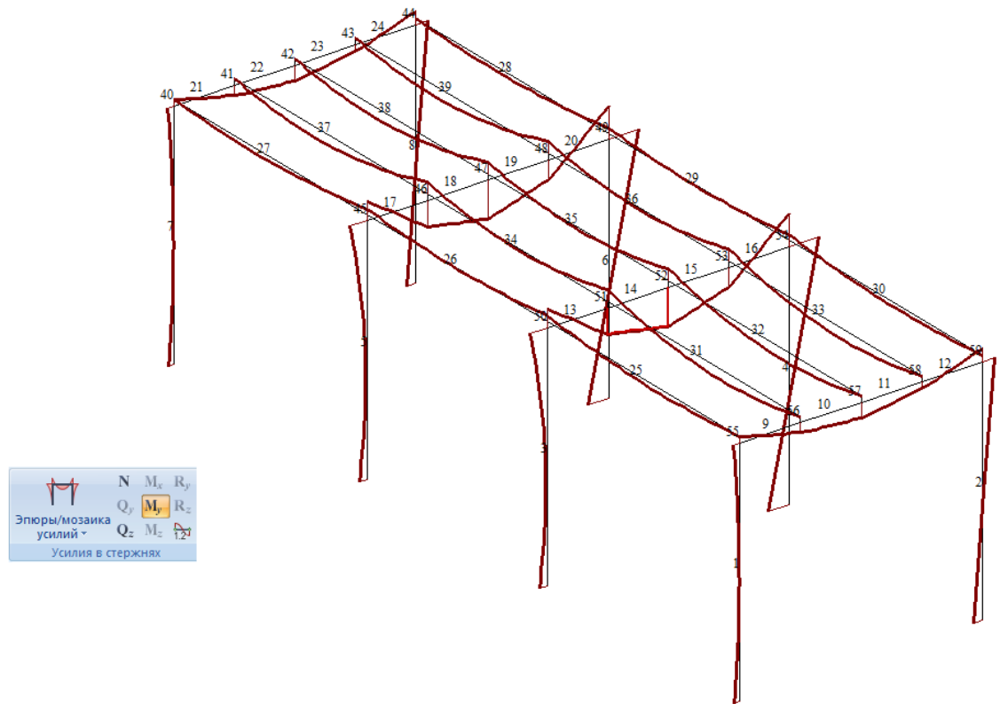
Рис. 2.15 Результаты статического расчета при введении до схемы КЕ 55, что моделирует пружинный зв'язок
