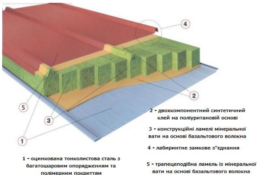
Рис. 1.5. Структура покрівельних панелей
