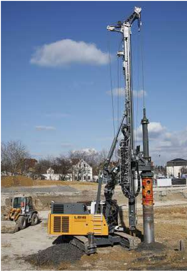
Рис.3.2. Зовнішній вигляд і габаритні розміри бурової установки Liebherr LB16.
