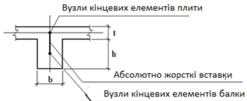
Рис. 2.9 Кінцевоелементна модель балочної плити із вставкою
