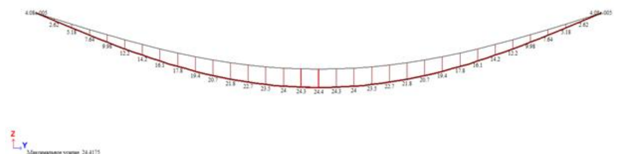
Рис. 2.12. Епюри моментів M_y в стержневих КЕ: модель 1-а; модель 2-б.
