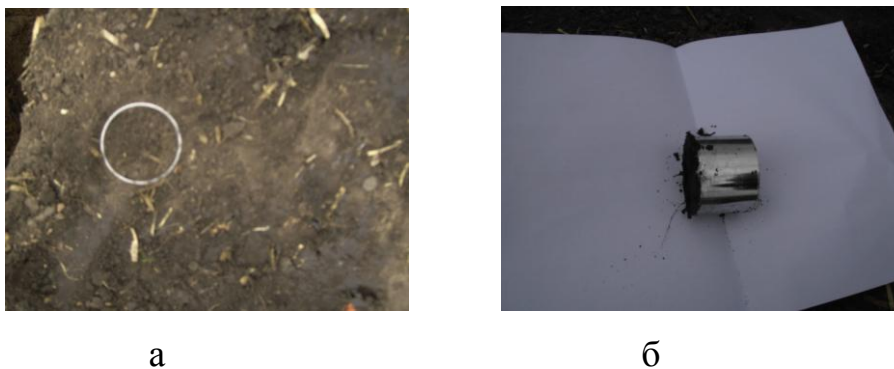
Рис. 3.2. Визначення щільності ґрунту: а – ріжучий циліндр в ґрунтовому шарі; б – ріжучий циліндр із ґрунтом після виймання з шару ґрунту
